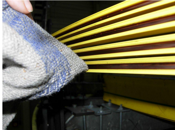
Bild 11: inställningsvinkel för rengöring av det nedre området
