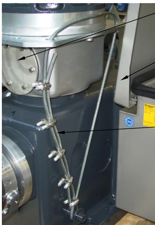
Bild 4.: Säkerhetssystem på den motordrivna kabelvindan
